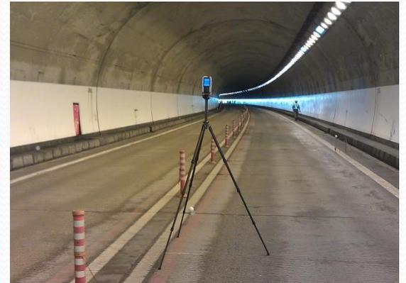
レーザースキャナの計測原理は、測定対象物にレーザーを照射して、距離と角度情報を取得し、3次元座標(XYZ)を取得するものです。
